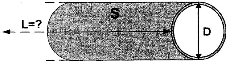
Cette surface doit pouvoir fournir une puissance thermique de  $P_S = 366$  kW et doit être calculée pour un coefficient global d'échange thermique entre vapeur et fuel égal à  $K_S = 110 \text{ W.m}^{-2}.\text{K}^{-1}$ . La température de la vapeur des serpentins et celle du fuel valent respectivement :  $\theta_V = 135^\circ\text{C}$  et  $\theta_F = 50^\circ\text{C}$ .
