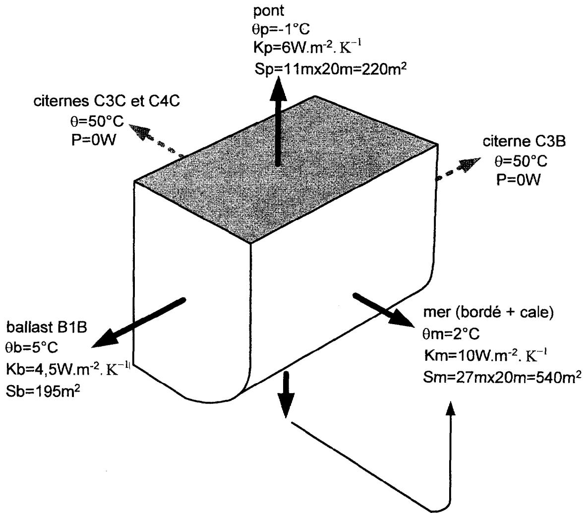
Étant donné le fort tirant d'eau du pétrolier, on considérera que tout le bordé est mouillé. Les températures de la mer, l'air du pont et l'air du ballast sont fixées pour les conditions climatiques les plus défavorables.
