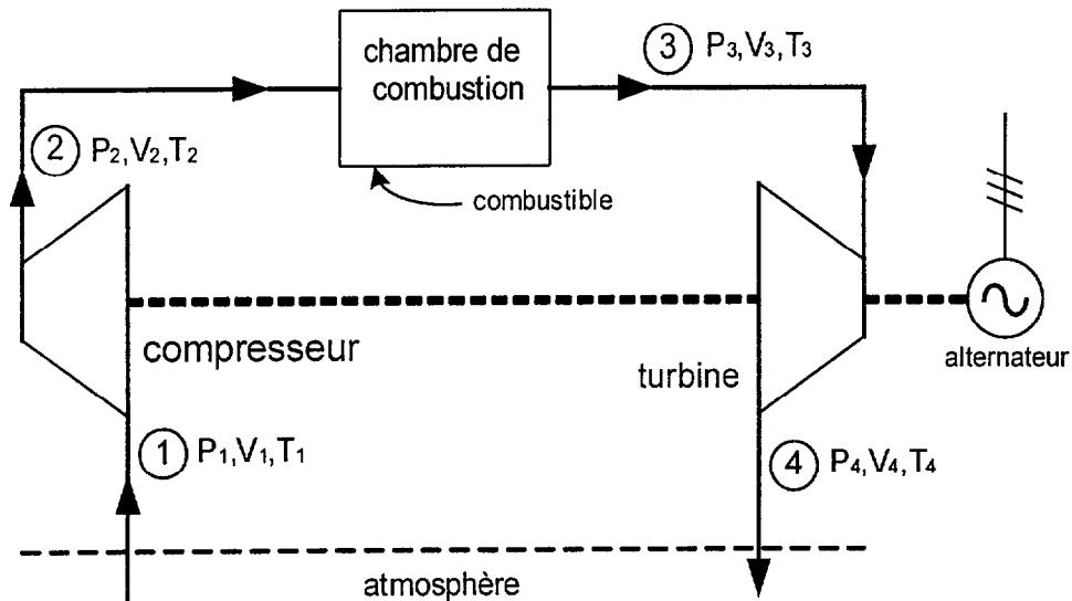
Elle comprend un **compresseur** qui puise l'air dans l'atmosphère, une **chambre de combustion** (dans laquelle l'air est brûlé) et une **turbine** alimentée par les gaz chauds issus de la chambre de combustion. La turbine comporte deux lignes d'arbres, l'une disponible pour l'entraînement du compresseur et l'autre pour l'entraînement d'un alternateur.
