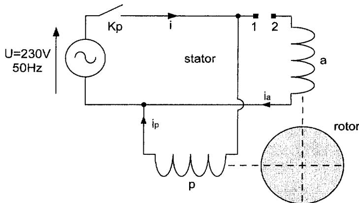
Les enroulements p (principal) et a (auxiliaire) du stator sont **identiques**.
