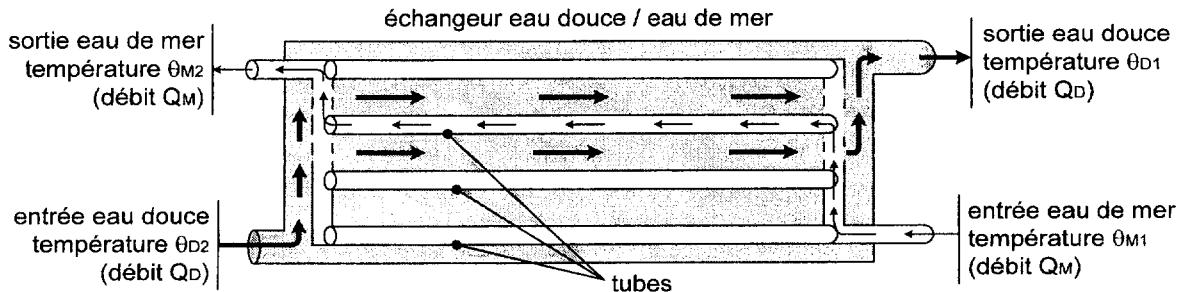
Le constructeur du moteur recommande des températures d'eau douce de  $\theta_{D1} = 65^\circ\text{C}$  à l'entrée du moteur et  $\theta_{D2} = 80^\circ\text{C}$  à la sortie. La température prévue d'eau de mer à l'entrée de l'échangeur est de  $\theta_{M1} = 30^\circ\text{C}$ . On note  $\theta_{M2}$  la température de l'eau de mer à la sortie de l'échangeur. Les débits  $Q_M$  et  $Q_D$  sont des débits volumétriques.
