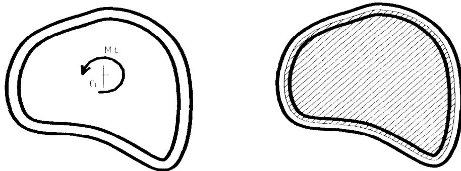
La contrainte tangentielle  $\tau$  due au moment de torsion est constante dans toute la section du tube et vaut :  $\tau = M_t / (2 \cdot \bar{S} \cdot e)$  avec :
